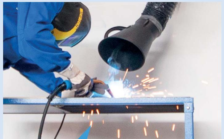
*Bei gelegentlichem Einsaugen von Funken wird durch den Einsatz des STAVO die Brandgefahr minimiert.*
