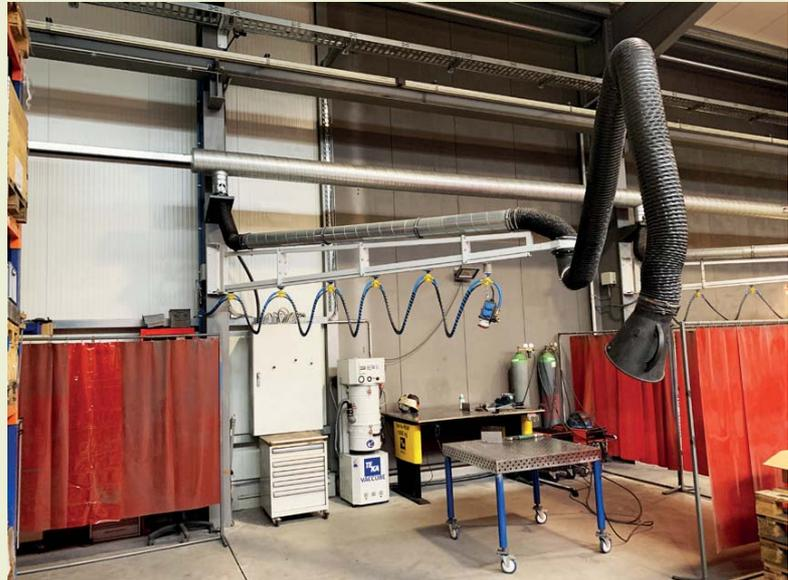
Absaugarm mit Wandausleger und Führungsschiene
