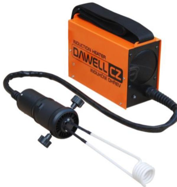
Durch die einfache Handhabung findet dieses tragbare Induktionsheizgerät auf Grund schneller Einsatzbereitschaft vor allem in Automobilwerkstätten und in der In ihre Anwendung. Das induktive Aufheizen ersetzt zu einem überwiegenden Teil die Anwendung mit Autogenschneidbrenner. Schnelles und sicheres Aufheizen erleichtert z.B. die Demontage verrosteter Schrauben.
