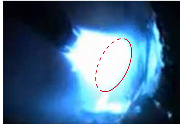
Jetzt: FOCUS.ARC Schweißprozess Konzentrierter Lichtbogen mit Energie im Zentrum
