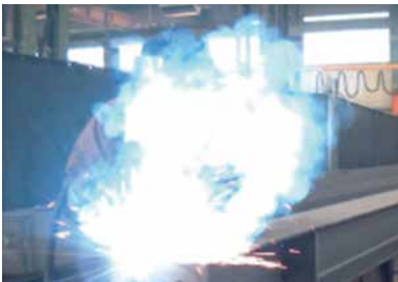
Bisher: Hohe Schweißrauchentwicklung im konventionellen Schweißprozess.
